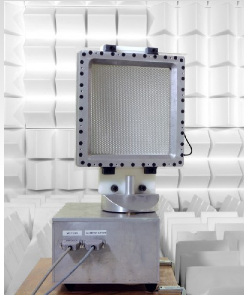
Haut-parleur ultradirectif constitué de 2372 cellules de PVDF (PolyVinylidene Fluoride) de diamètre 4 mm (LAUM)
