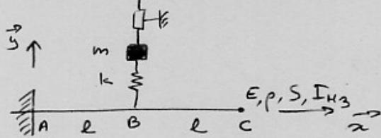
Soit une poutre droite de longueur  $2l$ , de module d'Young  $E$ , de masse volumique  $\rho$ , d'aire de section droite  $S$ , de moment quadratique autour de l'axe  $H_3$   $I_{H3}$ , et une masselotte de masse  $m$  assujettie à se translates uniquement dans la direction  $\vec{y}$  et reliée à la poutre par un ressort de rigidité  $k$ . On souhaite calculer la première fréquence propre de ce système mixte (continu et discret) par la méthode de Rayleigh.
