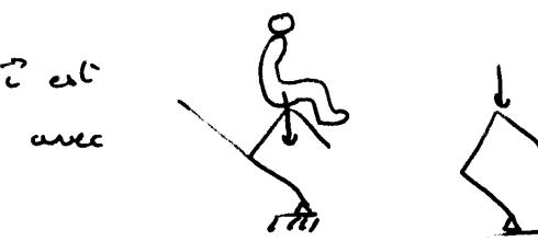
Calculons le cas b .... qui n'est certes pas le plus défavorable. La poutre est en compression pure la contrainte est  $\sigma_{mn}^b = -\frac{F}{\frac{\pi d^2}{4}}$
