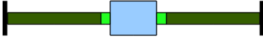
FIGURE 1.28 – Une masse liée au référentiel extérieur par deux poutres et deux ressorts.
