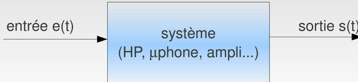
Le signal qui « sort » du système n'est généralement pas exactement le même que celui qui rentre, car le système a une certaine « réponse en fréquence »
